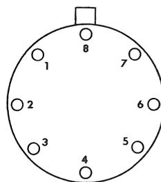
*Can-type IC Pin Numbering*
